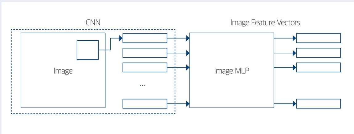
[그림] 사진 인코더 구조도
