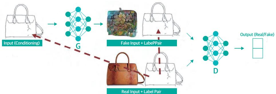
[그림] Generative Adversarial Network을 이용한 스케치 업샘플링 모델의 구조도
